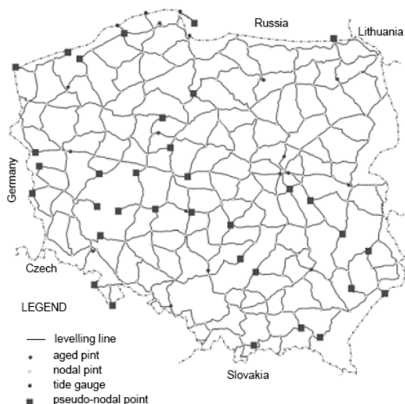
Fig. 1 First class levelling network (Kowalczyk, 2006).
