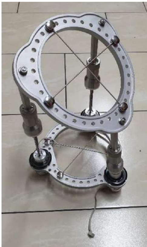
Obr. 1 Funkční vzorek zevního fixátoru použitého pro testování závislosti přenosu vysunutí z vnějších pilířů do kosti prostřednictvím K-drátů
