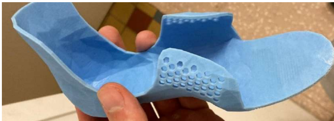
Obr. 5 AFO ortéza vyrobená pomocou 3D tlače
