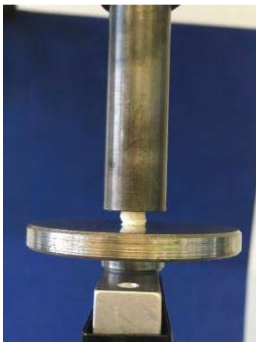
Obr. 1 Ukázka mechanické zkoušky kompozitních nosičů v suchém a hydratovaném stavu.
