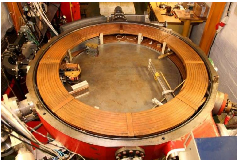
Obr. 1 Vakuová komora elektronového relativistického urychlovače elektronů - mikrotronu MT25.
