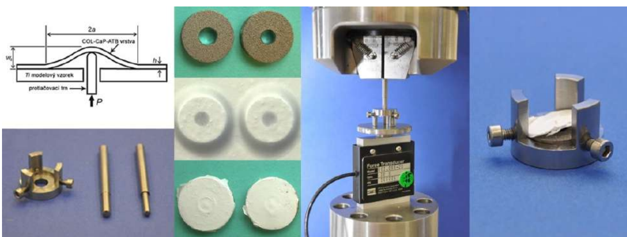
Obr. 1 Schéma uspořádání blister testu (vlevo nahoře) a přípravek pro uchycení testovaných vzorků (vlevo dole a zcela vpravo). Na snímcích uprostřed je zachycen postupný elektrostatický pokryv modelových vzorků a uspořádání při zatěžování na zkušební zařízení.
