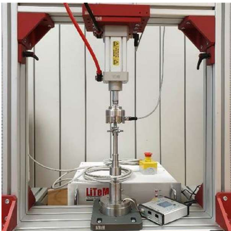
Obr. 3 Testování posuvníku ve stroji LITEM VDC-A-6
