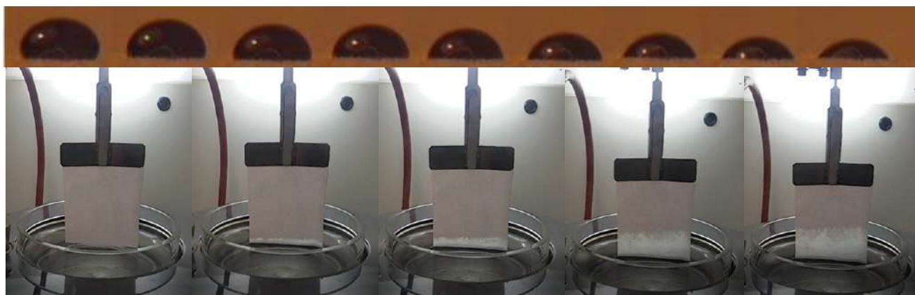
Obr. 1: Příklad vývoje změny kontaktního úhlu kapky vody obarvené metylenovou modří na elektricky zvlákněném nanovláknenném materiálu z PCL (nahore) a fotografie z měření vztlínání vody do elektricky zvlákněného materiálu z PCL pomocí mikrotensiometru.
