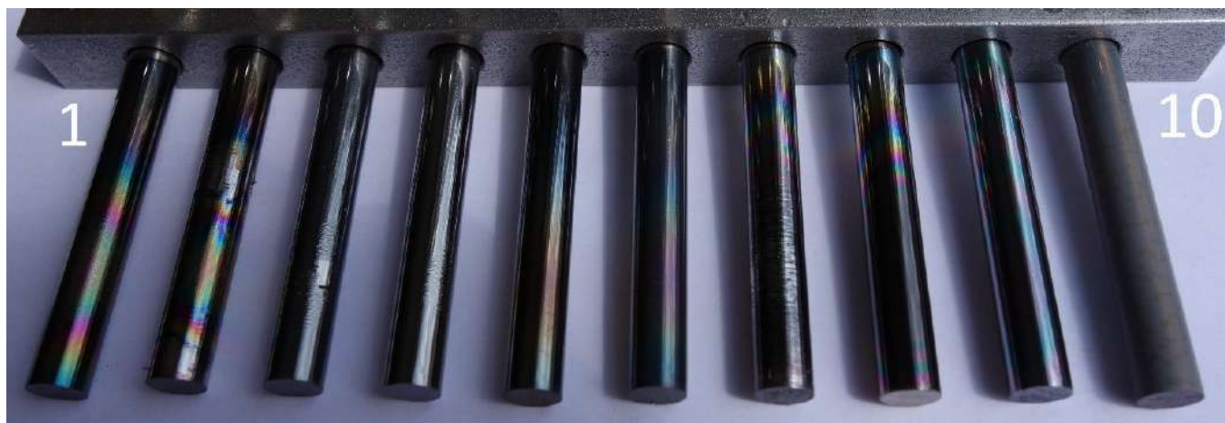
Obr. 2. Testovací tyče s povlaky: 1,2 – DLC; 3,4 – Cr:DLC; 5,6 – Gradientní Cr:DLC; 7,8 – YSZ; 9 – TiO 2 (Terč TiO 2 ); 10 – TiO 2 (Terč Ti)
