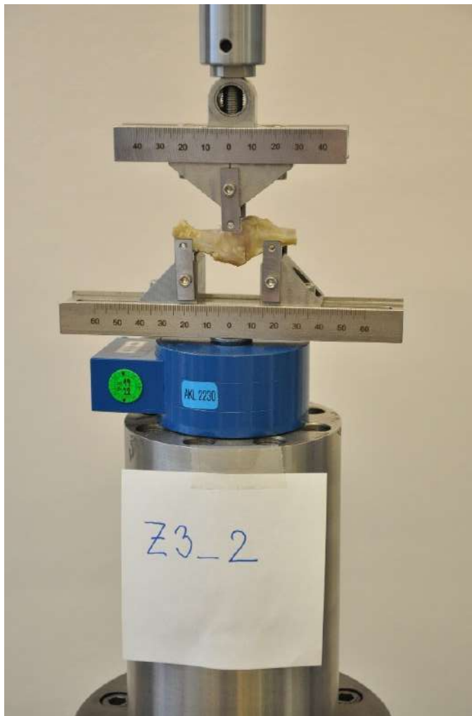
Obr. 1 Silový snímač, speciální přípravek pro tříbodový ohyb a vzorek Z3_2
