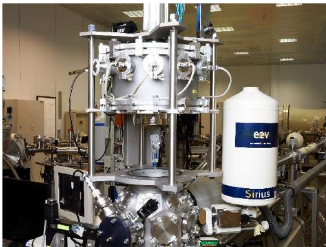
Obr. 1. Komora mikrosvazku s držákem vzorků a vnitřní uspořádání detektorů, kamer a mikroskopu.
