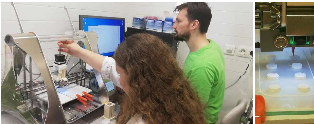
Obrázek 1: Metoda přímého tisku inkoustu – tzv. robocasting kompozitní pasty do tvarů tablet dle CAD modelu. Po tisku jsou vzorečky vytvrzeny při 100% vlhkosti a 37 °C po dobu 1–7 dnů.
