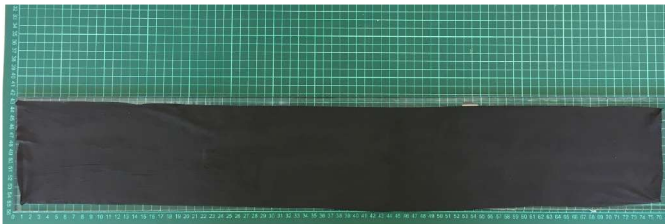
Obr. 1 Polykaprolaktonová nanovláknenná vrstva s obsahem grafenu
