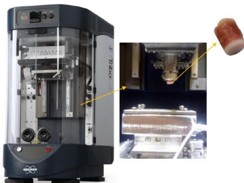
Obr. 2 Experimentálne zariadenie (Tribolab Bruker – VUT v Brne), chrupkový pin
