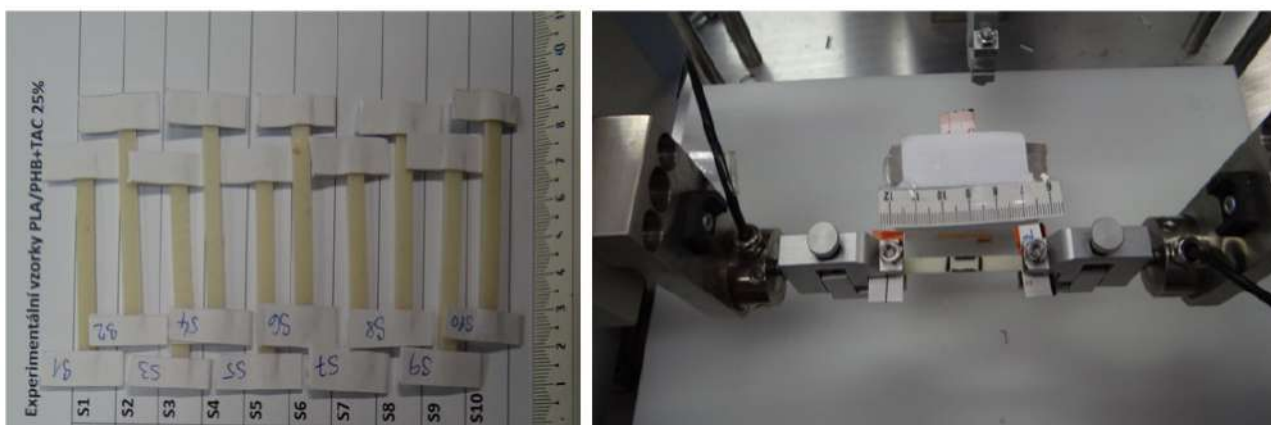
Obr. 1 Vzorky 3D tlačeneých PLA-PHB prúžkov, upnutý PLA-PHB prúžok do čelustí trhacieho zariadenia.
