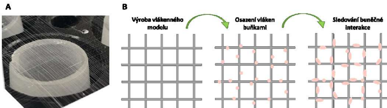
Obr. 1 Příprava vlákněného modelového systému metodou drawing (A) a schéma testování buněčné interakce s vlákněným modelem (B).
