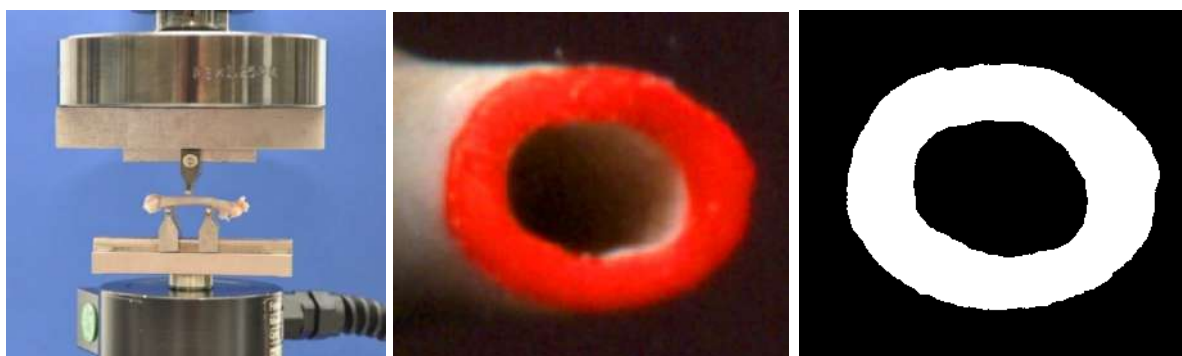
Obr. 1 Potkaní femur umístěný před zatížením v přípravku pro tříbodový ohyb na testovacím systému MTS Mini Bionix (vlevo), naskenovaný řez femuru (uprostřed) a řez po provedení obrazové analýzy (vpravo), kdy je následně zjištěn modul průřezu v ohybu kosti a s jeho využitím pak pevnost kosti.
