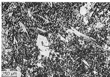
Obr. 6. Kostrovitý vývoj olivínu a pyroxenu v odlité dlaždici z čediče Podhora.
