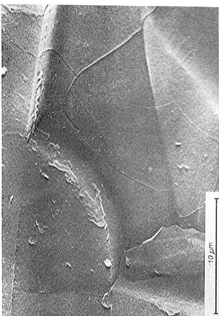
Obr. 4. Snímky REM lomové hrany pro zřetelnějšího zobrazení šupinkovitě struktury a pokrácování trhlínkovité struktury pod povrchem skla. Původní povrch skla je na obrázcích nahoře a dole je vidět na něj kolmá a později vzniklá lomná plocha. Zřetelně lze rozeznat horizontální a vertikální tvorbu trhlínek. Po odstranění „šupinky“ (4b) lze rozeznat pokrácování trhlínky v podkladu.
