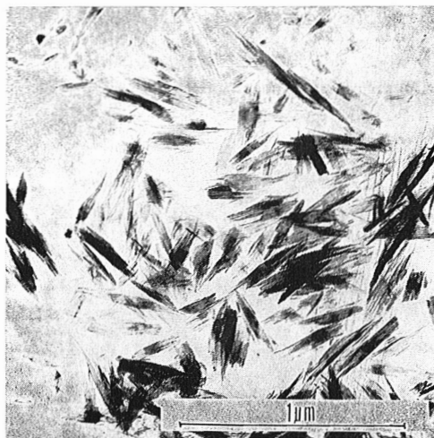
Obr. 1. Fázově čistý \gamma -FeOOH (lepidokrokitu) z prozařovacího el. mikroskopu.
