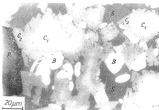
Obr. 1. Štruktúra chrómkorundo-baddeleyitového materiálu ER 216 v oblasti asi 10 3 mm pod povrchom odlitku; B — baddeleyit, C 1 — svetlá jadra krystalů chrómkorundu, C 2 — tmavší lemy krystalů chrómkorundu, S — skelná fáze, P — uzavřený pór. Odražené světlo.
