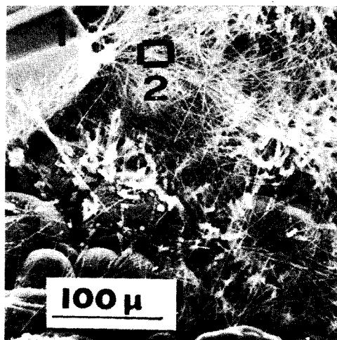
Obr. 3. Lomová plocha expandující kaše bezsádrovcového cementu (měrný povrch  $300 \text{ m}^2/\text{kg}$ ) po 28 dnech hydratace,  $w = 0,27$ . Rastrovací mikroskop. Analýza EDAX: kryštalové útvary — bod 1 ...  $C/S$  i  $C/A \geq 10$ , vláknité útvary — plocha 2 ...  $C/S > 10$ ,  $C/A$  cca 5,9.
