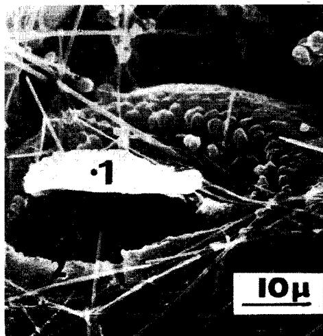
Obr. 4. Detail lomové plochy expandující kaše bezsádrovcového cementu (měrný povrch  $300 \text{ m}^2/\text{kg}$ ) po 28 dnech hydratace,  $w = 0,27$ . Rastrovací mikroskop. Analýza EDAX: body 1 a 2 ...  $C/S$  a  $C/A \geq 10$ .
