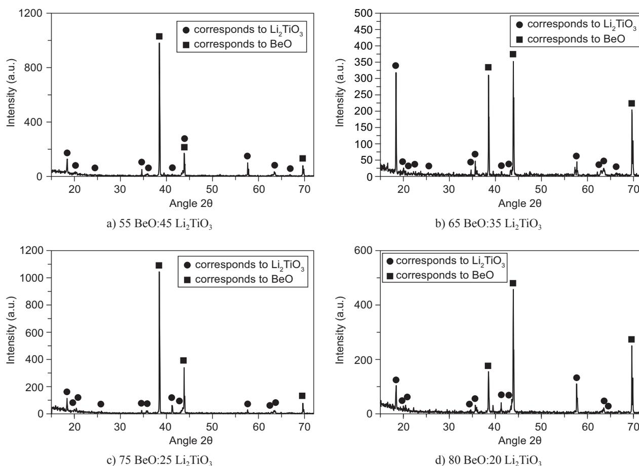
Figure 2. XRD scans for a) 55 BeO:45 Li<sub>2</sub>TiO<sub>3</sub> sample, b) 65 BeO:35 Li<sub>2</sub>TiO<sub>3</sub>, c) 75 BeO:25 Li<sub>2</sub>TiO<sub>3</sub>, d) 80 BeO:20 Li<sub>2</sub>TiO<sub>3</sub>
