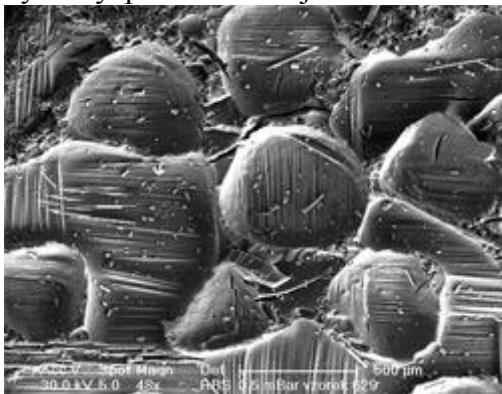
Obrázek 1: Vlevo: Studovaný povrch kompozitu na bázi skel (velikost pórů 400-600 μm), vpravo: detail otevřeného póru
