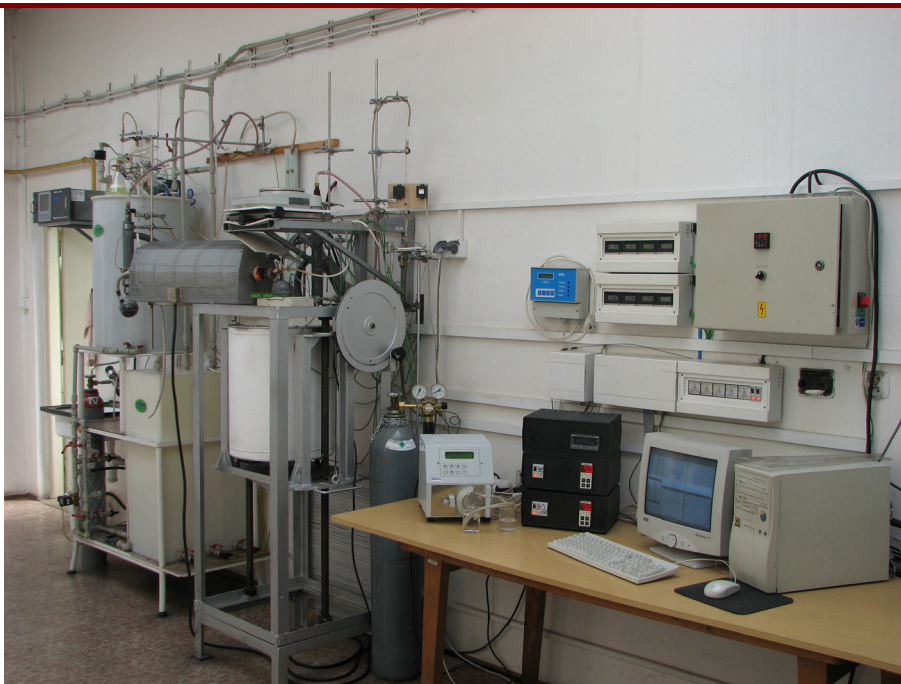
Obr. 6 Laboratorní zařízení pro pyrolýzu a zplyňování směsí za vzniku vodíku
