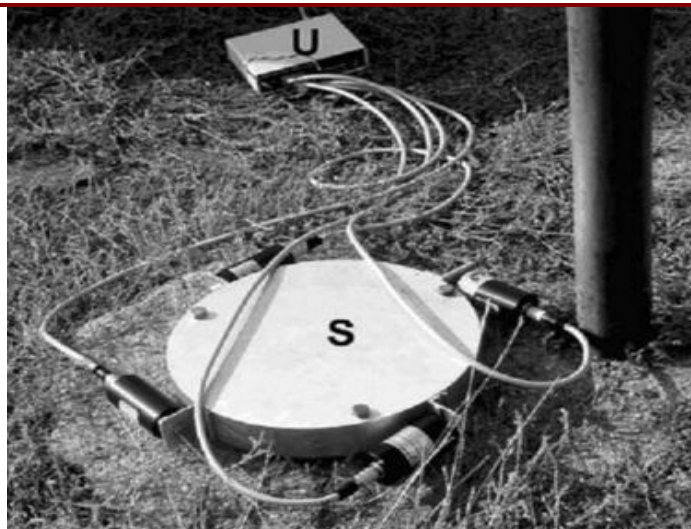
Obr. 5: Nový přenosný typ rotačního seismometru Rotaphone.
