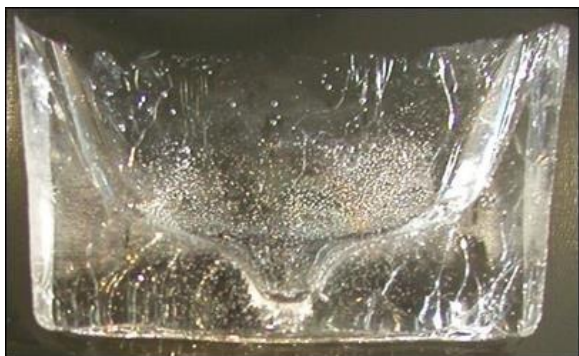
Obr. 2 (ID 729): Řez vychlazeným vzorkem skla po experimentu, který probíhal za odstředivých podmínek (ca 240 otáček/min) a vysokých teplot (~1400 °C). Na vnitřních stěnách vzorku jsou vidět nahromaděné bubliny.
