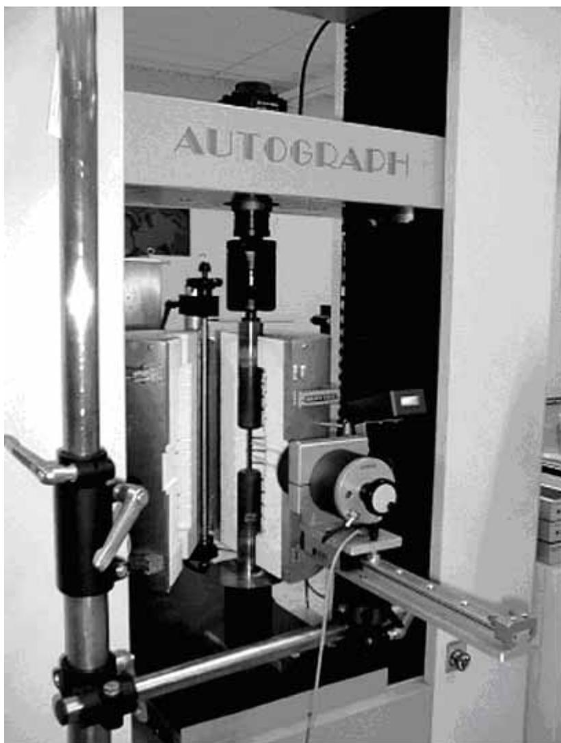
Na fotografii je měřicí rám a příprava pokusu v tahovém uspořádání (pootevřená pec s válcovým pracovním prostorem, v popředí vpravo držák vysokoteplotního extenzometru Maytek zasahujícího při měření do pece). Přístroj byl pořízen v rámci projektu P2046110 „Analýza chování komplexních systémů“, zařazeného do Programu podpory rozvoje přístrojového vybavení progresivních vědních oborů AVČR. Bude využíván při řešení projektů zaměřených na výzkum teplotně stálých kompozitů a jiných materiálů.
