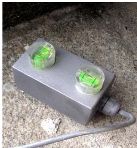
snímač SM6-3D (geofony SM6b); 28.8V/(m/s)
