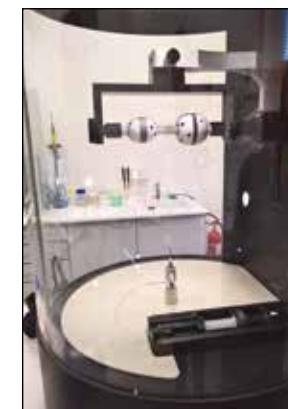
Zařízení 4SPIN (Contipro a.s.) je využíváno pro elektrostatické zvlákňování polymerních roztoků, zejména polymerů přírodního původu, jako je kolagen, či pro pokryv implantátů (na snímku jsou jamky totální náhrady kyčelního kloubu)
