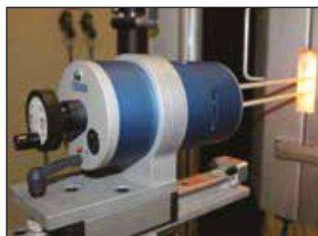
Zařízení Inspekt 100 (Hegewald & Peschke) umožnuje mechanické zkoušky materiálů při vysokých teplotách, rok 2018, foto Vlasta Mádlová
