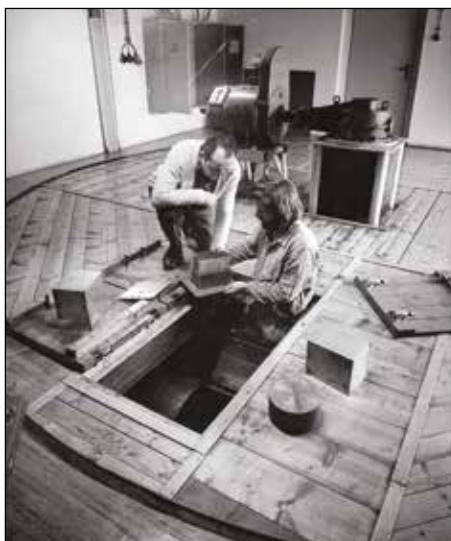
Modelovací stand pro měření rozložení deformací kolem důlních děl, bez datace, foto Karel Fink
