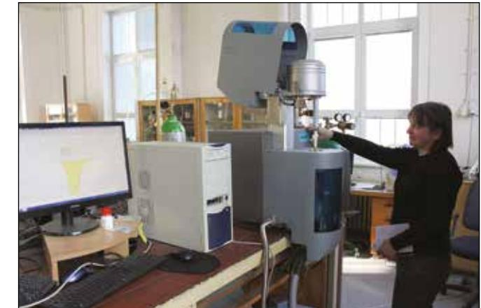
Rentgen-fluorescenční analyzátor Spectro IQ pro analýzy hlavních a stopových prvků v pevných, práškových i kapalných materiálech, rok 2018, foto Vlasta Mádlová
