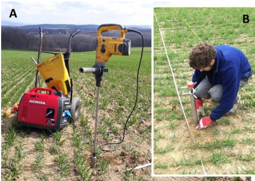
Příprava seismického měření: (A) předvrtávání otvorů pro střílený seismický zdroj; (B) utěšňování stříleného seismického zdroje (tzv. „buffalo gun“) v předvrtaném otvoru. (foto: Petr Tábořík)
