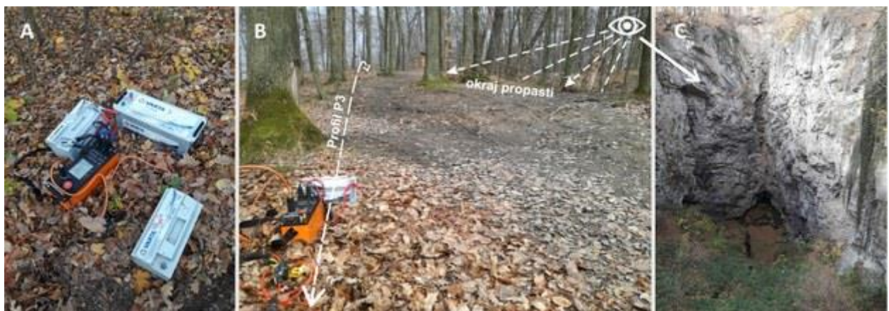
Měření elektrické odporové tomografie v profilu těsně vedle Hranické propasti. (A) přístroj Ares II s připravenými náhradními bateriovými zdroji; (B) průběh profilu v těsné blízkosti propasti; (C) pohled na jezírko „na dně suché části“ Hranické propasti. (foto: Petr Tábořík)
