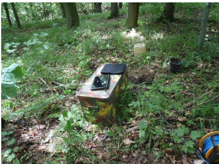
Audiomagnetotelurická sonda pro hluboká měření geoelektrických vlastností podloží. (foto: Radek Klanica)
