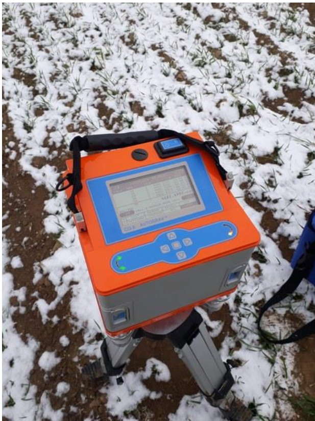
Gravimetrické měření pomocí přístroje Scintrex Autograv CG-6. (foto: Radek Klanica)
